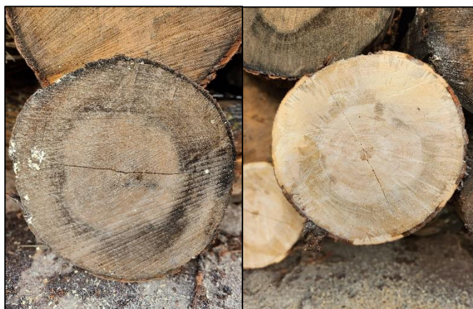
2.attēls. Kokmateriāls ar koksnes vainu aplievas iekrāsojums nozāģēta 5cm ripa (attēla kreisā puse) un kokmateriāls pēc ripas nozāģēšanas (attēla labā puse)
