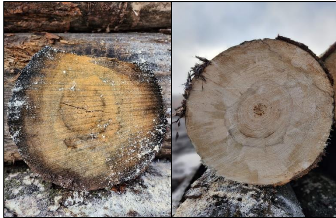
2. attēls. Kokmateriāls ar koksnes vainu aplievas iekrāsojums nozāģēta 5cm ripa (attēla kreisā puse) un kokmateriāls pēc ripas nozāģēšanas (attēla labā puse)
