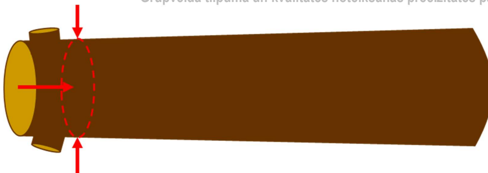
2. attēls. Caurmēra uzmērīšana, tievākajā vietā
