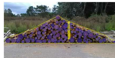
Grēdu tilpuma noteikšana pēc kraujmēra metodes
